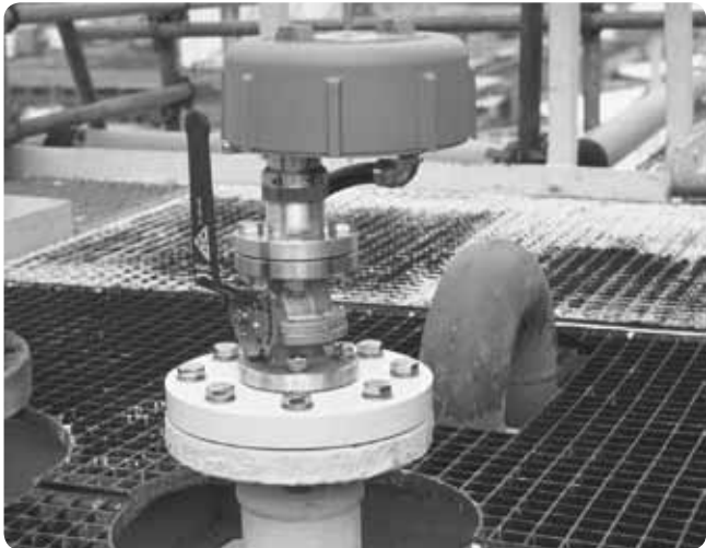
Obr. 3 Vďaka inteligentnému radarovému vysielaču možno presne zmerať výšku hladiny.
